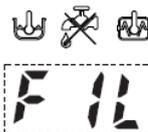
Осторожно, данный тип машины подает воду в бак при помощи серии последовательных циклов горячего ополаскивания – все это время на дисплее горит надпись «FILL» - «ПОДАЧА ВОДЫ».
