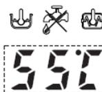
Для того чтобы вывести на дисплей температуру воды в бойлере во время нагрева воды в баке, следует открыть капот и нажать на клавишу «G» (Табл. 2 «Панель управления»).
