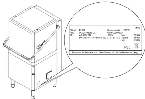
Рис. 2 - Местоположение шильдика и маркировки
