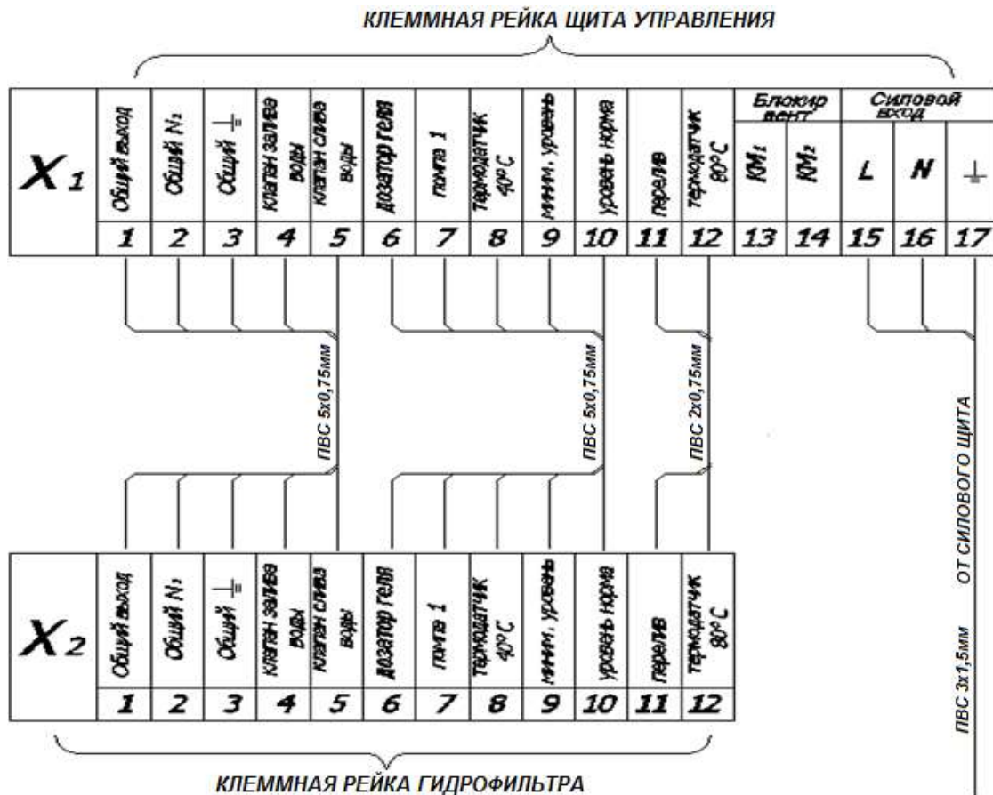
Рис. 12. Межблочная схема Гидрофилтра «Safe Fire»
