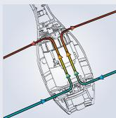
Система воздушного охлаждения позволяет долго работать без перегрева
