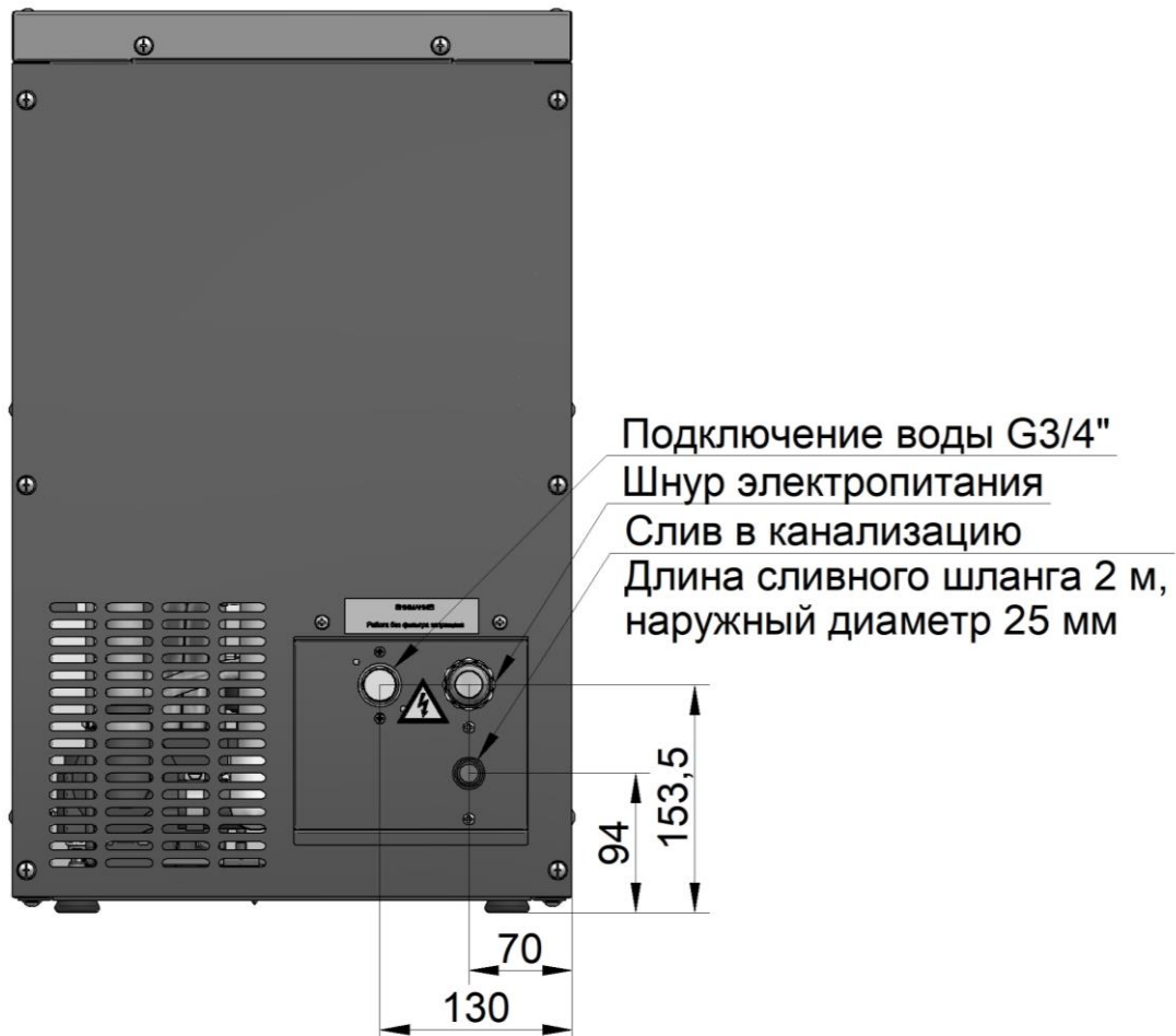
Рис. 5 Схема подключения льдогенератора
