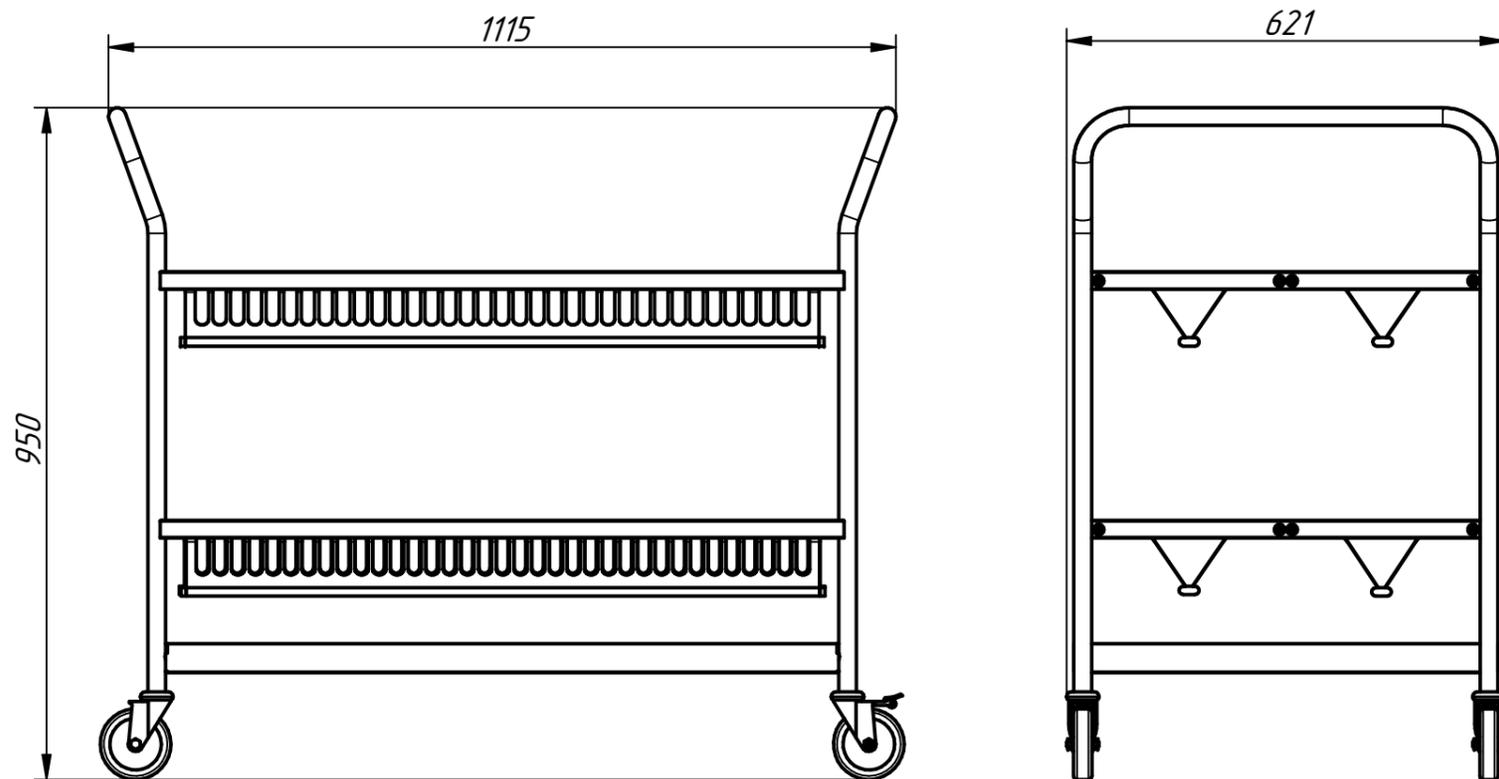
Тележка для сушки тарелок ТСТ является вспомогательным оборудованием на предприятиях общественного питания и используется для сушки и транспортировки тарелок. Количество одновременно загружаемых тарелок – 140 штук. Ванночка внизу тележки служит для сбора стекающей с тарелок жидкости. Тележка имеет четыре поворотных колеса большого диаметра, два из которых имеют стопор. Все детали тележки изготовлены из нержавеющей стали.
