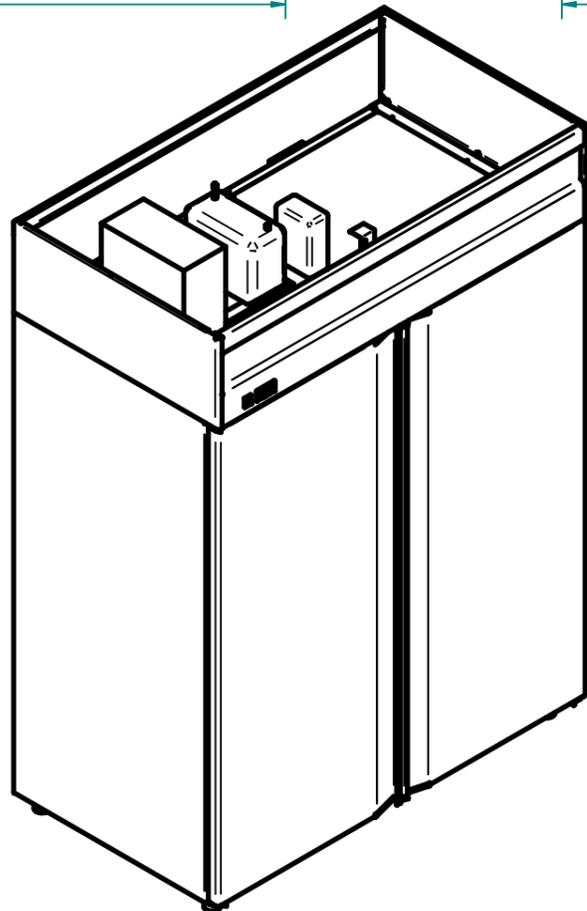
Шкаф холодильный типа ШХ-1,4 (ШХн-1,4;ШХс-1,4) с верхним расположением агрегата предназначен для хранения пищевых продуктов в охлажденном или замороженном состоянии на предприятиях общественного питания и торговли.
