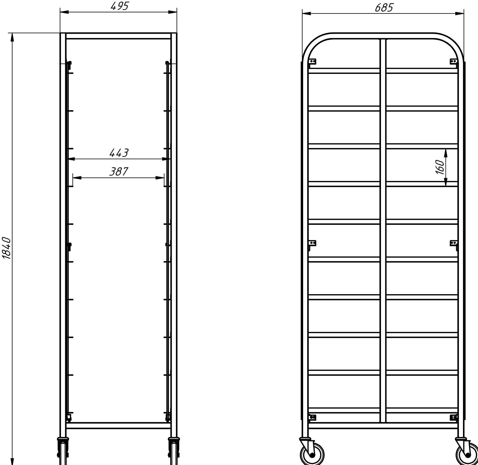
Тележка шпилька для подносов является вспомогательным оборудованием для предприятий общественного питания и используется для установки и транспортировки 10 подносов размером 430x550 мм. Тележка имеет поворотные колеса, два из которых оборудованы стопором.
